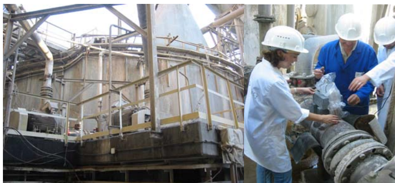
Fig. 3. Optimisation de la production d'acide phosphorique à l'aide de techniques faisant appel aux radiotraceurs dans une usine tunisienne.
