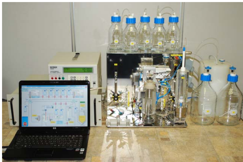
Fig. 1. « Kamadhenu », un générateur électrochimique de strontium 90/d'yttrium 90 entièrement automatique conçu et construit par Isotope Technologies Dresden à partir d'une technologie mise au point dans le cadre d'un PRC de l'Agence. (Crédit photo : J. Comor)
