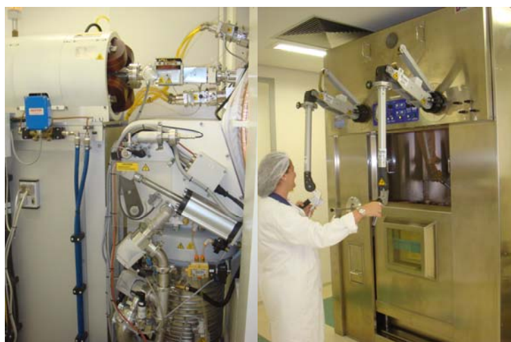
Fig. 2. Système d'extraction de faisceaux du cyclotron (à gauche) et cellule chaude de production (à droite) pour la fabrication de radionucléides pour la PET à Recife (Brésil).
