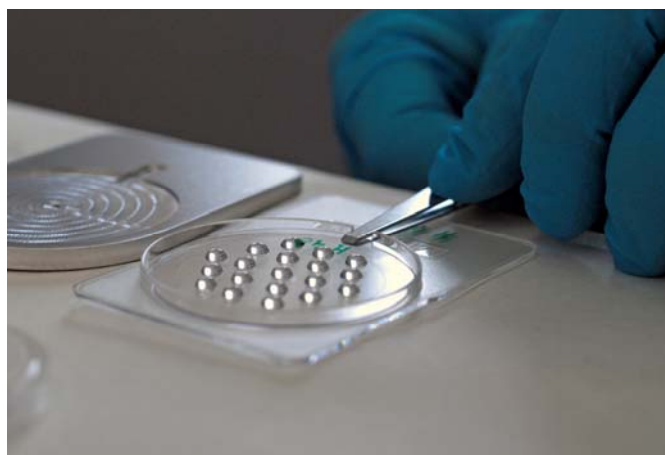
Fig. 4. Préparation de matières de référence pour filtres à air simulés aux fins du test de compétence ALMERA.
