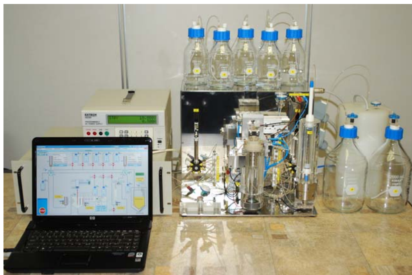
图 1. 由德累斯顿同位素技术公司利用通过原子能机构一个协调研究项目开发的技术设计和制造的一种全自动镥-90/钇-90 电化学发生器“Kamadhenu”（照片由杰·科默提供）。
