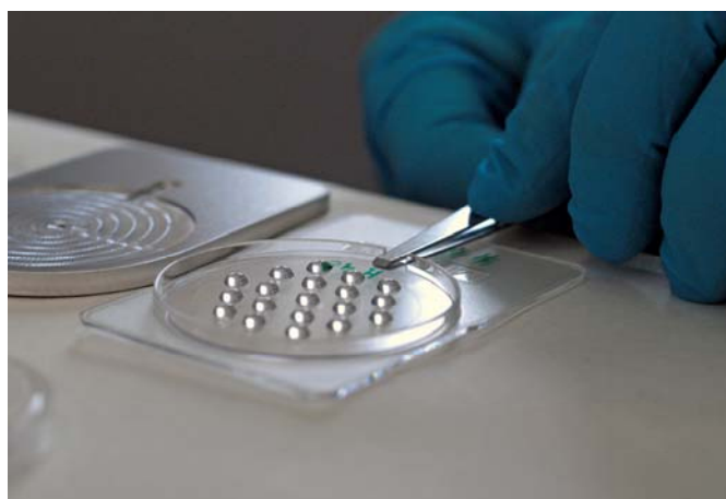
图 4. 为进行测量环境放射性分析实验室网水平测试制备模拟空气过滤器参考材料。
