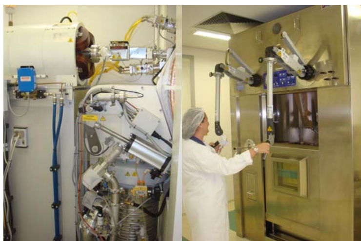
图 2. 巴西累西腓一台生产正电子发射断层照相用放射性核素的回旋加速器束引出装置（左）和生产热室（右）。
