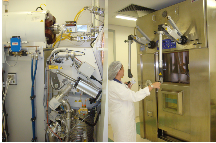
الشكل ٢. مستخرج حزم السيكلوترونات (على اليسار) وخبلة إنتاج ساخنة (على اليمين) لتصنيع النويدات المشعة للتصوير المقطعي بالانبعاث البوزيتروني في ريسيف بالبرازيل.
