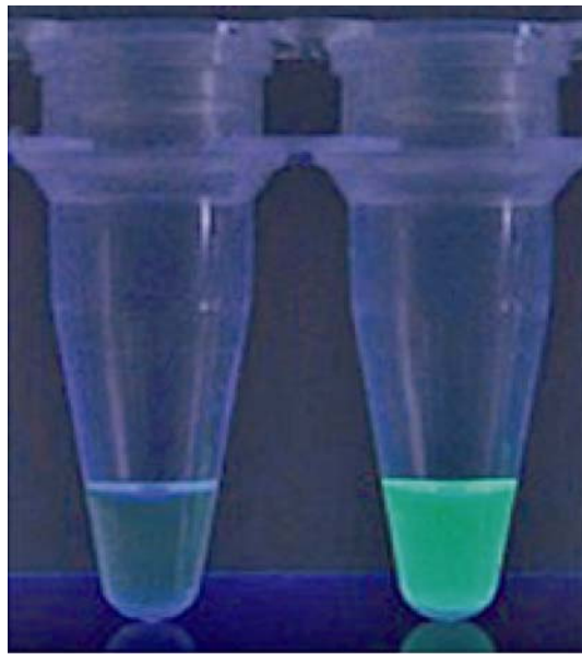
الشكل ٤. استخدام صباغ أخضر اللون لقياس التآلق يتيح تفسيراً بصرياً لنتيجة اختبار التضخيم المتساوي درجة الحرارة بواسطة حلقات للكشف المبكر والسريع عن الأمراض الحيوانية العابرة للحدود مثل انفلونزا الطيور الشديدة العدوى.
