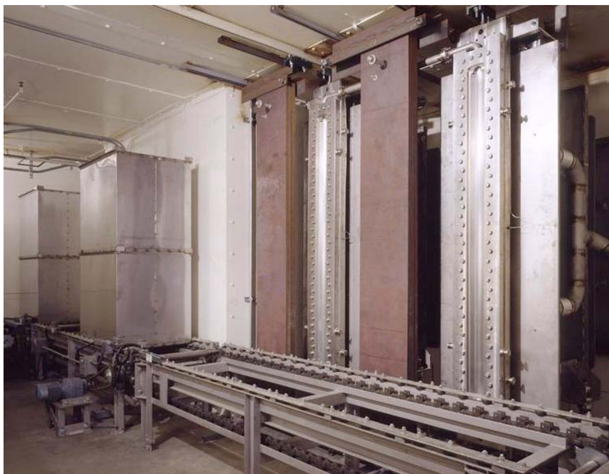
图 I-2. 正在输送装有材料（如一次性医疗用品、粮食产品）的容器，用 5 兆电子伏至 7.5 兆电子伏的电子束作 X 射线处理。
