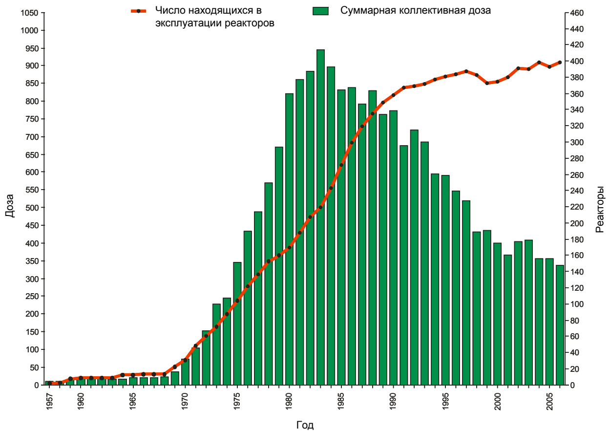
Рис. 2. Изменение суммарной годовой коллективной дозы (чел.-Зв) и число находящихся в эксплуатации реакторов
