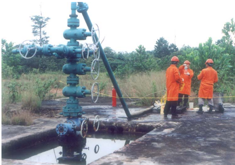
图 1. 注入氚化水作为在印度尼西亚一座油田开展井间试验的示踪剂。
