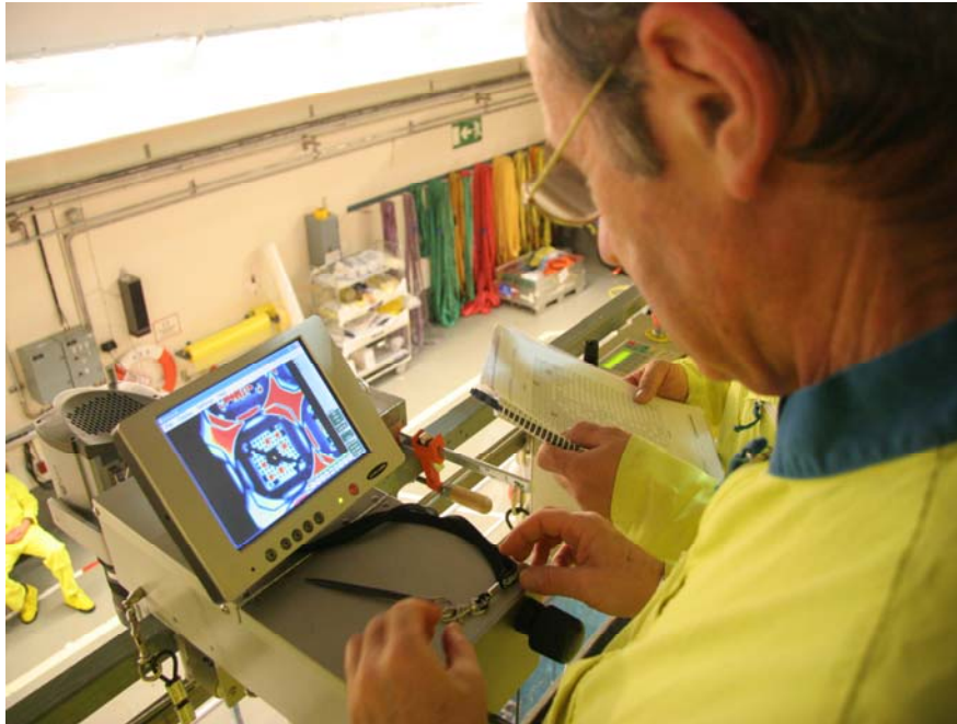
图 2. 利用数字式切伦科夫观察装置对乏燃料进行核查。
