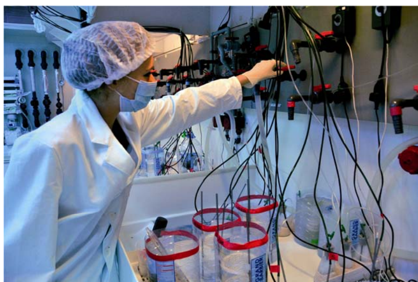
图 1. 原子能机构海洋环境实验室的实验系统用于评定在气候变化模型预测的 pH 值降低的情况下海水对商业海产品的影响。
