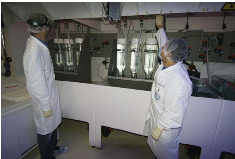
Nueva instalación para evaluar los efectos de la acidificación de los océanos en las larvas de peces de importancia comercial en el Laboratorio de Radioecología del Organismo en Mónaco
