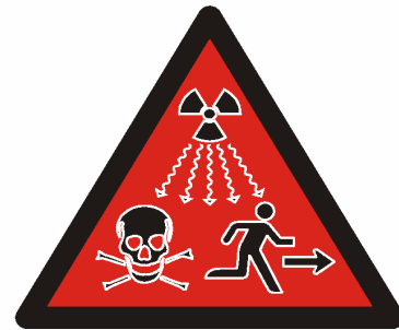
Figura 2: Advertencia de la presencia de radiación ionizante – símbolo complementario
