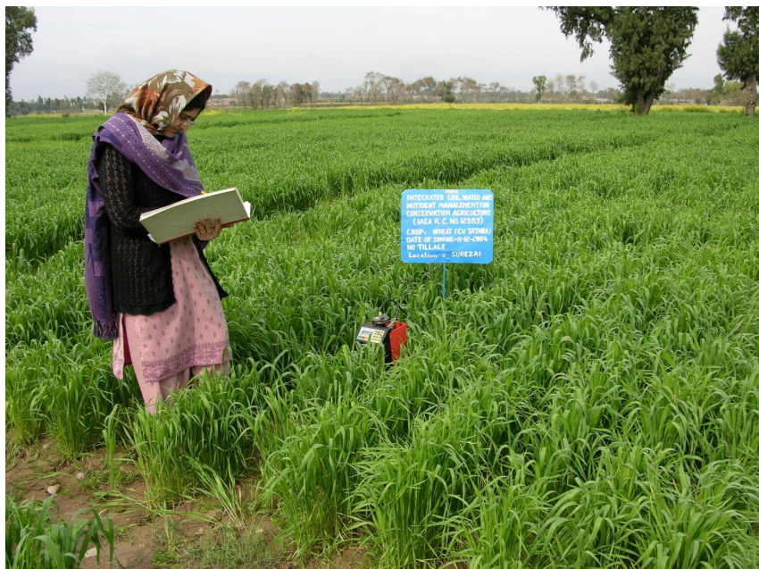
Mejor gestión del riego mediante la sonda de neutrones para medir la humedad del suelo
