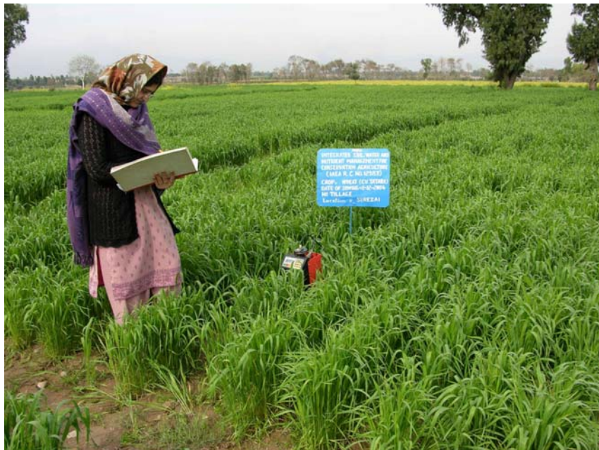
РИС. 2. Улучшение организации оросительных работ благодаря использованию нейтронного почвенного влагомера
