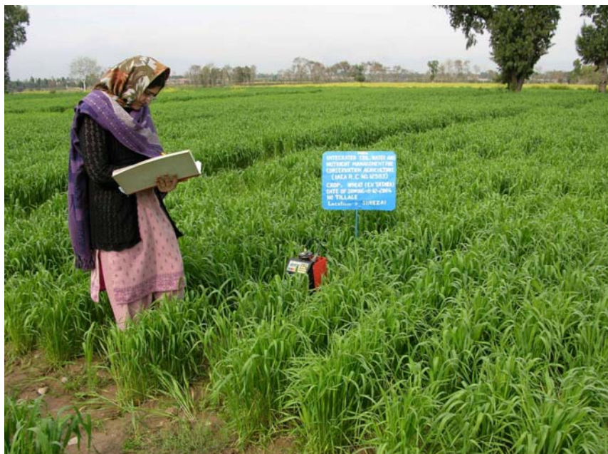
图 2. 利用土壤湿度中子探针加强灌溉管理
