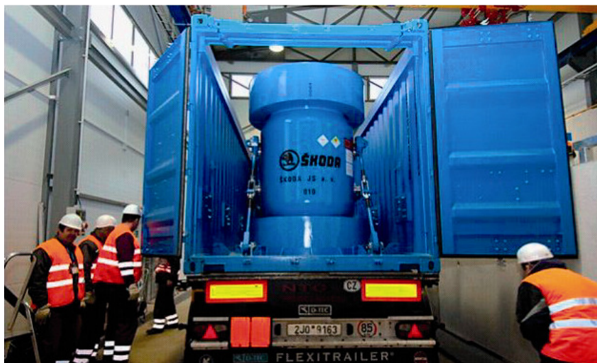
Fig. 2. Cofre de gran capacidad utilizado en la expedición de combustible gastado procedente de Řež (República Checa).
