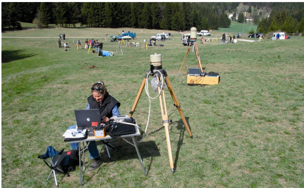
Fig. 2. Sistemas de espectroscopia gamma de alta resolución sometidos a prueba en condiciones de campo en el ejercicio hipotético de intercomparación in situ realizado en Austria.
