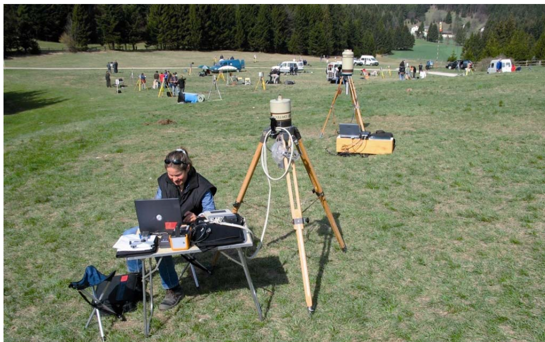
FIG. 2. Essai sur le terrain de systèmes de spectrométrie gamma à haute résolution lors de l'exercice de comparaison in situ organisé en Autriche.
