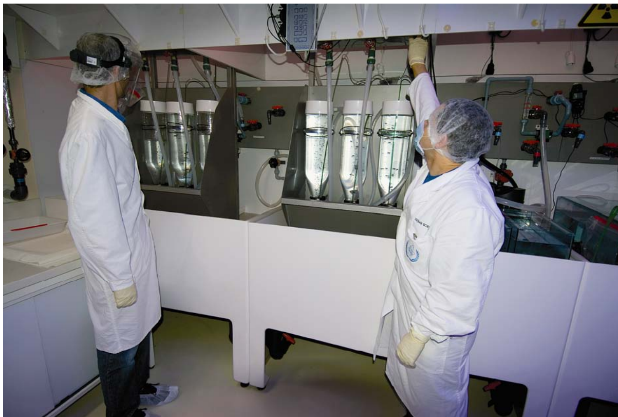
FIG. 1. Nouvelle installation pour étudier les effets de l'acidification des océans sur les larves de poissons commerciaux.
