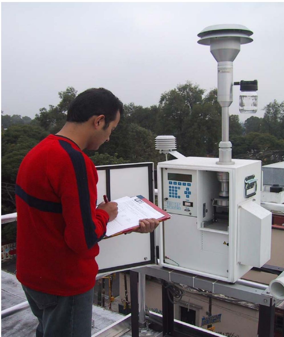
Рис. 11. Техник собирает текущие оперативные данные на устройстве для отбора проб взвешенных в воздухе микрочастиц на станции атмосферного мониторинга в Койоакане в столичной зоне Большого Мехико. (Фото любезно предоставлено Национальным институтом ядерных исследований, Мехико.)
