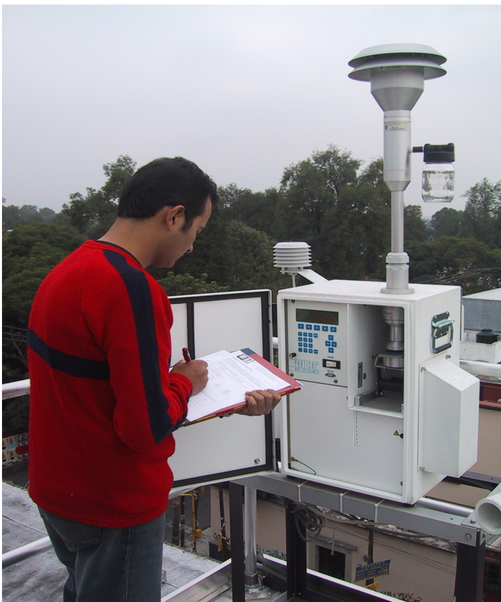
الشكل ١١ - تقني يجمع بيانات التشغيل الراهنة من جهاز لأخذ عينات هوائية تحتوي على جسيمات دقيقة في موقع أخذ العينات الجوية الكائن في "كويواكان"، بمنطقة مدينة المكسيك الكبرى. (الصورة مقدّمة من المعهد الوطني للبحوث النووية بالمكسيك.)
