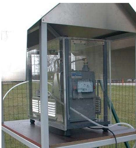
Fig.H-3: Analizador de aire de gran volumen para vigilar la contaminación atmosférica o la presencia de radón.
