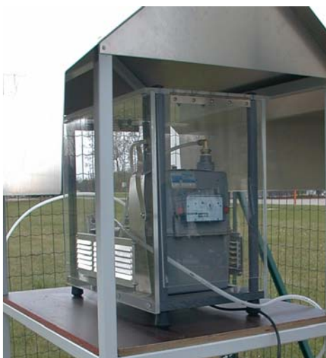
Рис. Н-3. Воздушный пробоотборник для забора большого объема, используемый при мониторинге загрязнения воздушной среды или содержания радона
