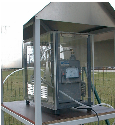
الشكل حاء-٣: جهاز ذو طاقة عالية لأخذ عينات من الهواء، يستخدم في حالات تلوث الهواء أو رصد الرادون
