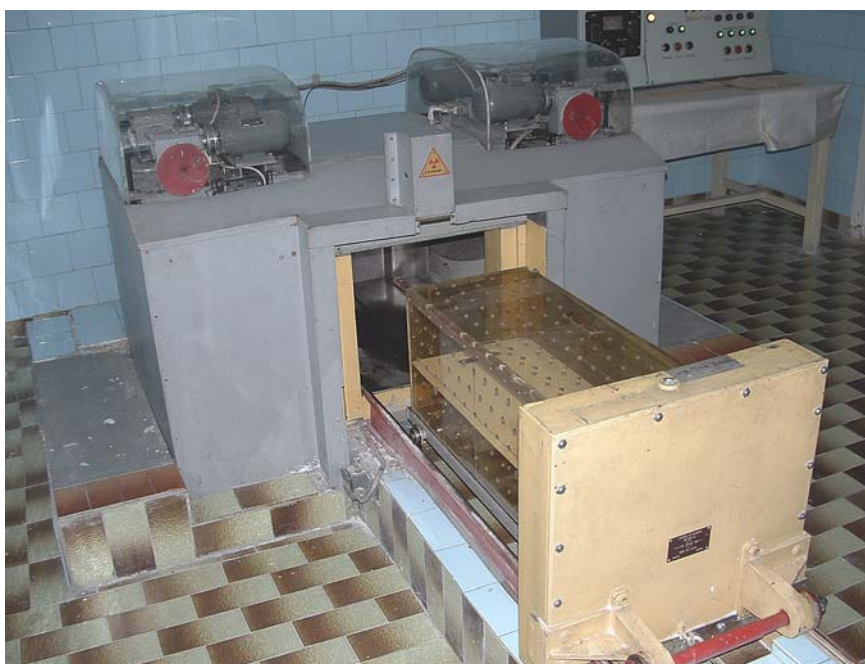
Рис. 1. Старая облучательная установка с источниками цезия-137 в Болгарии перед снятием с эксплуатации.
