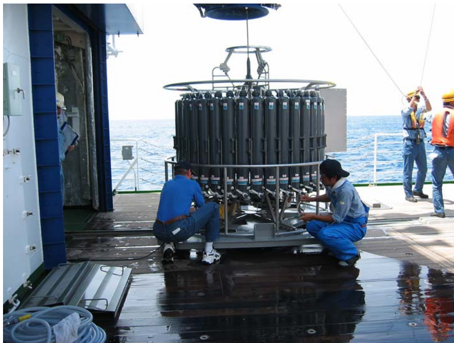
Рис. 2. Отбор проб морской воды и частиц для измерения природных радиоизотопных индикаторов.
