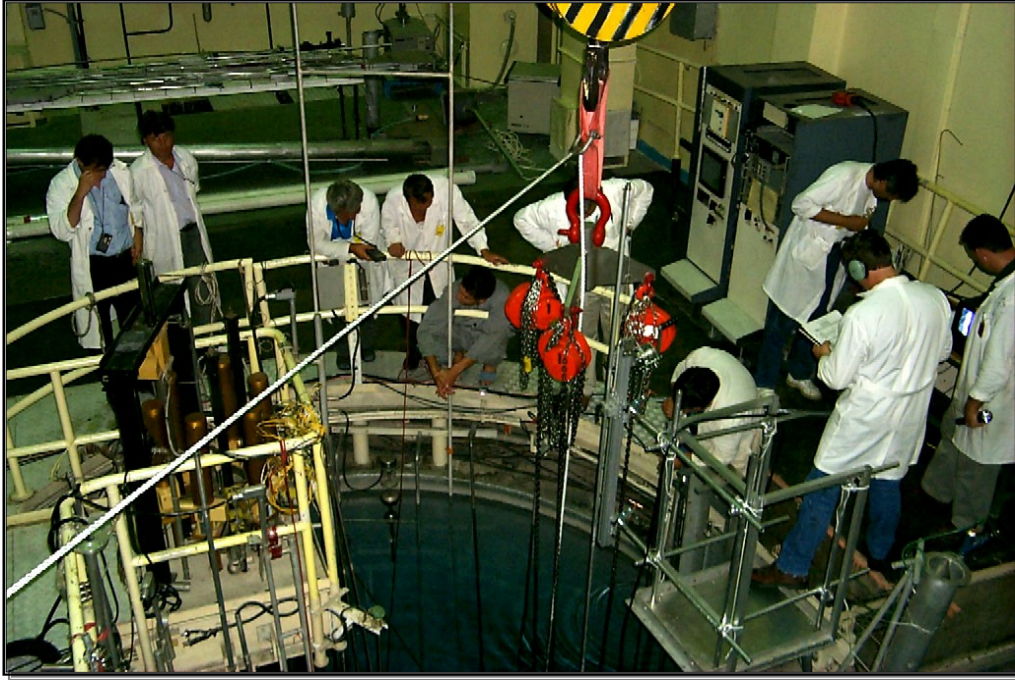
في رومانيا، تم تحميل وقود يورانيوم ضعيف الإثراء طازج داخل مفاعل بيتيستي البحثي في كانون الثاني/يناير ٢٠٠٥، وذلك بعد إزالة وقود اليورانيوم الشديد الإثراء من قلب المفاعل وتحضير هذا الوقود لإعادته إلى بلد المنشأ.
