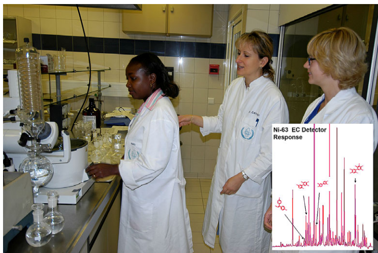
РИС. 1. Исследование и подготовка в ЛМС МАГАТЭ по извлечению пестицидов из морской биоты. На вставке показано газовое хроматографическое разделение и обнаружение индивидуальных пестицидов.
