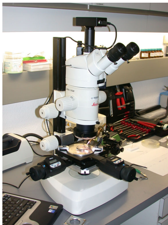
РИС. 3. Система для манипулирования микрочастицами, смонтированная в Лабораториях Агентства в Зайберсдорфе.
