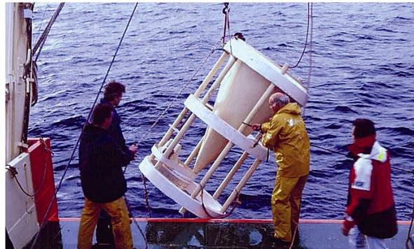
*Рис. 1. Погружение улавливателей частиц для измерения изотопов и степени поглощения углерода в океане.*
