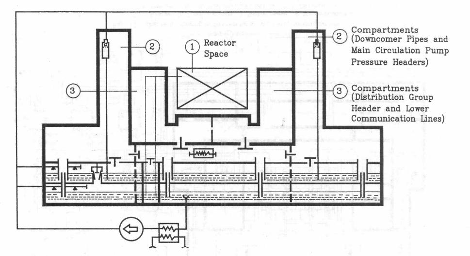
Fig. 12 SCHEMATIC DIAGRAM OF PART OF THE CONTAINMENT SYSTEM ("ACCIDENT LOCALISATION SYSTEM") 136
