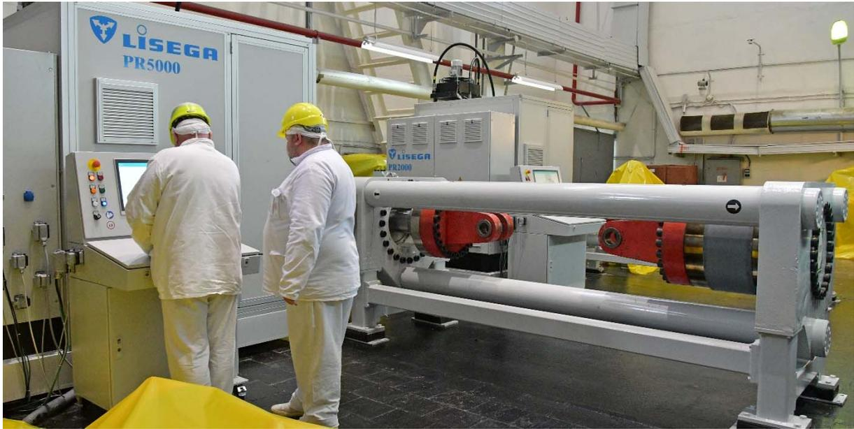
2025年4月24日，罗夫诺核电站工作人员在P-500静态测试台上进行测试。
