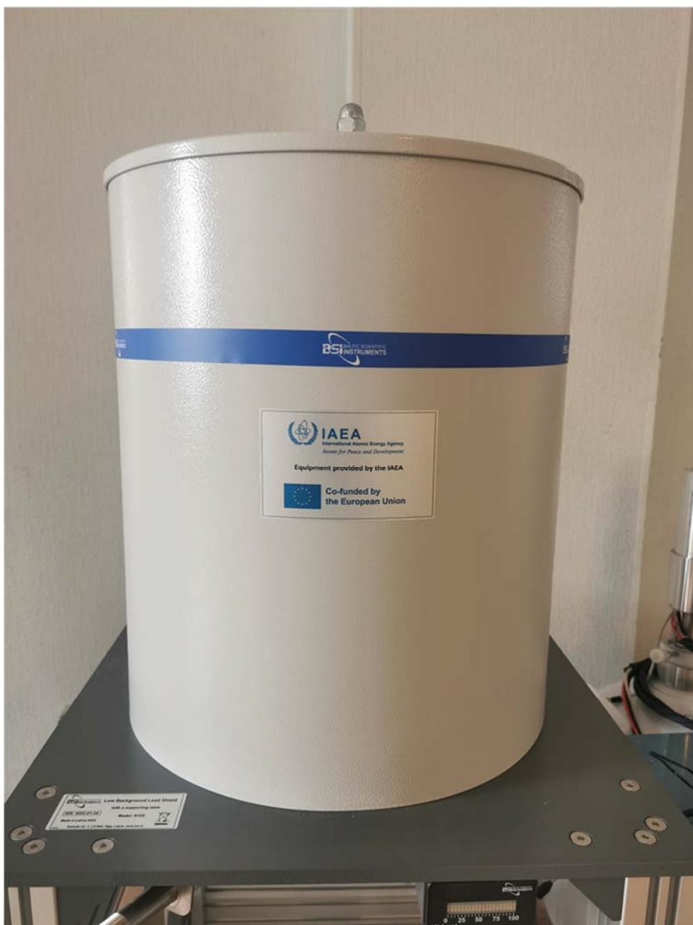
2025 年 3 月 12 日，向罗夫诺地区水文气象中心、乌克兰水文气象中心和乌克兰国家紧急情况服务部水文气象组织交付了配有高纯锗探测器的  $\gamma$  能谱仪。
