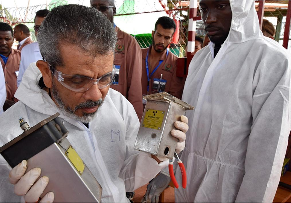
在实际操作活动中，参加培训人员在观看原子能机构专家拆除以前用在工业环境中的弃用放射源。（图/原子能机构O. Yusuf）
