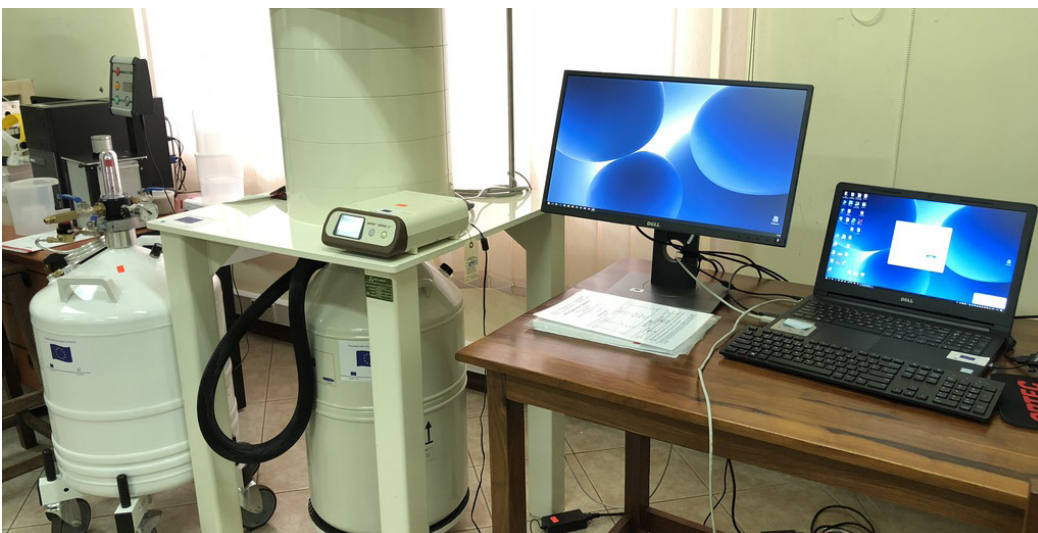
Le matériel du laboratoire d'analyse de l'uranium comprend un système de spectrométrie gamma, qui permettra aux autorités d'évaluer correctement l'uranium découvert dans le pays.
