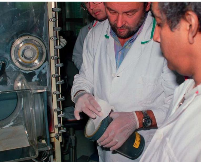
**Инспекторы производят отбор проб окружающей среды на ядерном объекте.**
