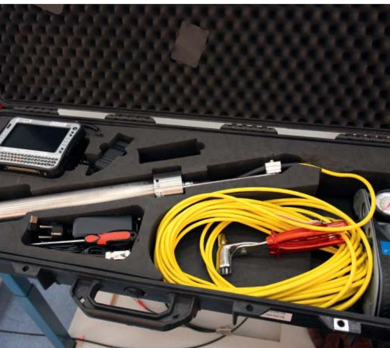
защитную трубку, которая опускается в бассейн выдержки отработавшего топлива для замеров характеристик находящихся в нем объектов. Детектор проводами соединен с анализатором, который располагается рядом с бассейном.
