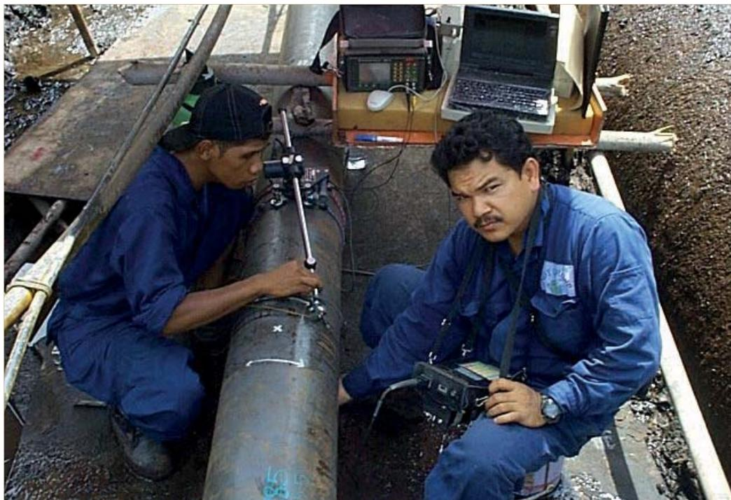
При проверке качества трубопровода компании “Петронас” технические специалисты обследуют одну из труб методом НРИ.
