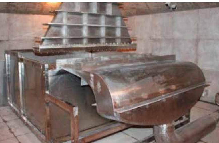
**C'est dans l'enceinte de balayage du faisceau d'électrons que les eaux usées peuvent être irradiées par des faisceaux d'électrons à haute énergie.**
