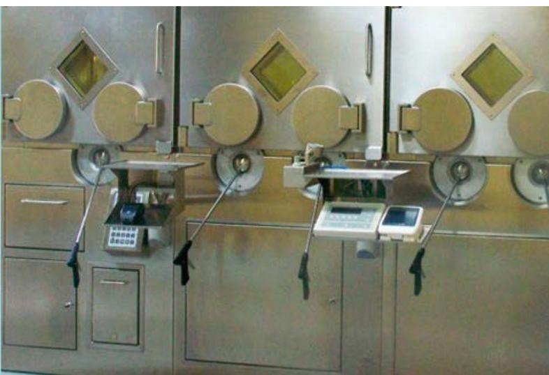
**La nouvelle installation de production de radiopharmaceutiques à base de  $^{90}\text{Y}$  dispose de cellules chaudes conformes aux bonnes pratiques de fabrication pour protéger les travailleurs et produire des médicaments de haute qualité.**
