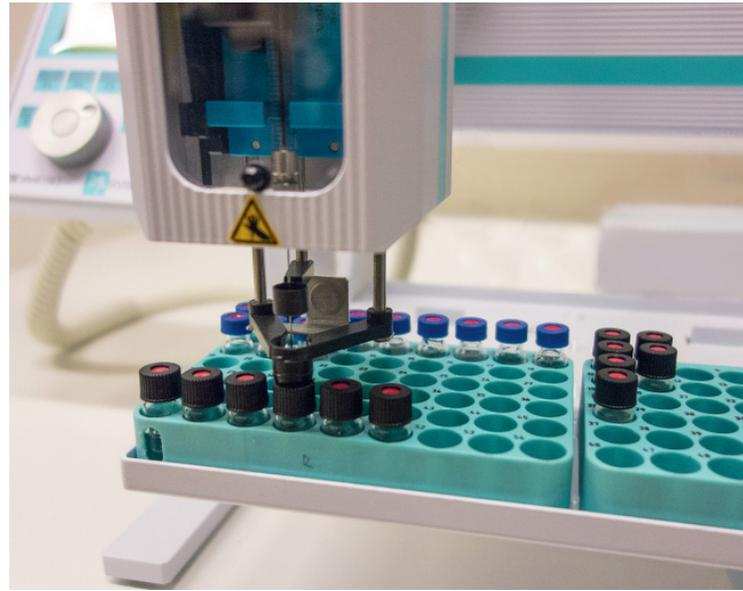
**6** Процесс измерения содержания стабильных изотопов в воде методом ЛАС становится более эффективным благодаря использованию автоматического пробоотборника. Автоматизация процессов позволяет не только сэкономить время и силы ученых, но и добиться более стабильных результатов применяемой процедуры, что важно для столь чувствительного метода.
