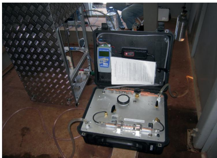
**4** Изотопные методы помогают в изучении динамики поверхностных вод и их взаимодействия с подземными водами, течей в плотинах и последствий изменения климата для освоения и хозяйственного использования водных ресурсов. На фотографии – пробоотборное устройство для измерения содержания инертных газов и изотопов в подземной воде.
