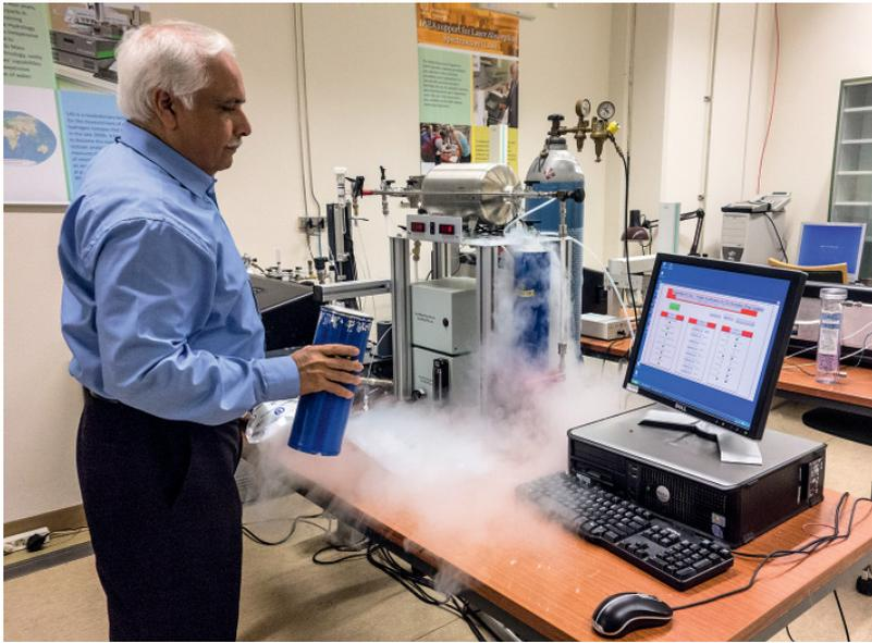
**5** Один из способов, при помощи которого ученые проводят анализ содержания изотопов углерода в воде, горной породе,  $\text{CO}_2$  и растворенном углероде, – это лазерная абсорбционная спектрометрия (ЛАС). Как явствует из названия, в ЛАС используются лазеры для определения типов и концентрации изотопов на основе оценки того, как они взаимодействуют с исследуемым объектом.
