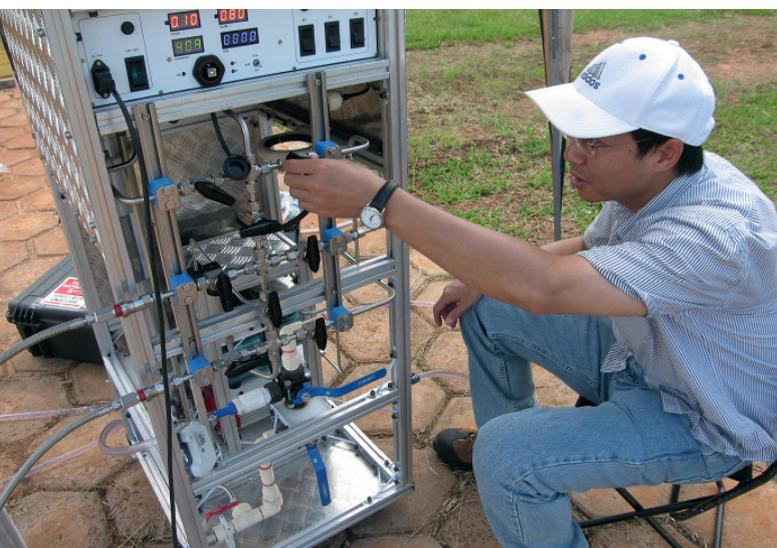
**3** С помощью изотопных методов можно определять происхождение, возраст и скорость восполнения запасов подземных вод, а также вероятность их загрязнения. Они дают возможность быстрого и уверенного составления карт невозобновляемых ресурсов подземных вод, большинство из которых залегают в трансграничных водоносных горизонтах. Такие изотопы, как криптон-81, используются для датирования глубоко залегающих и очень старых водоносных слоев.
