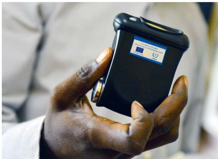
**6** Реагирование на инцидент, связанный с физической безопасностью, и смягчение его последствий требуют специализированного оборудования, такого как определитель изотопов, а также наличия компетентного и хорошо обученного персонала.
