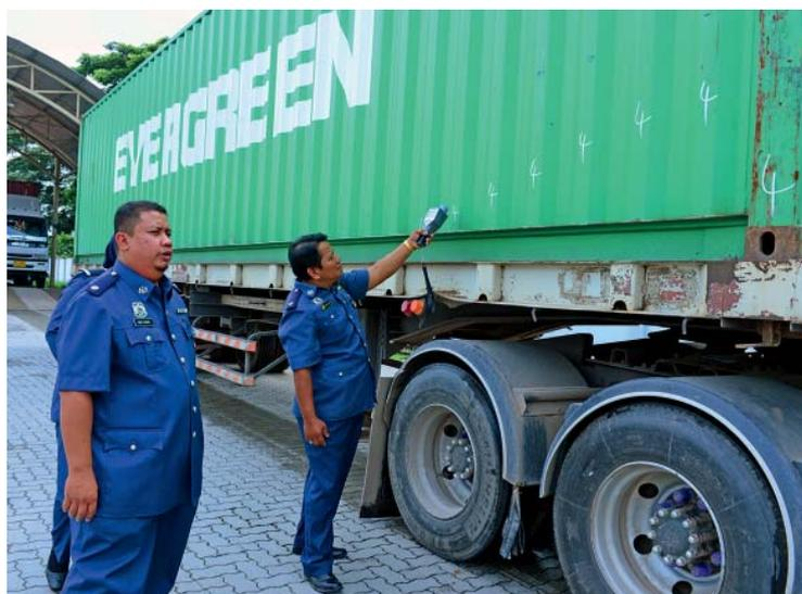
8 Если таможенники считают, что содержимое вызывает подозрение, они с помощью переносных детекторов излучения проводят детальную оценку излучения. Это оборудование дает им возможность точно определить радионуклид и место нахождения данного материала.
