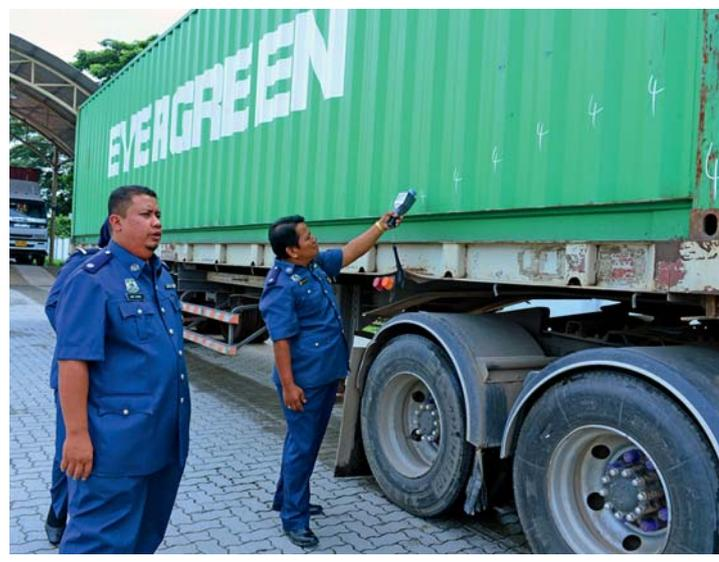
**8** Si los funcionarios de aduanas determinan que el contenido es sospechoso, llevan a cabo una evaluación radiológica detallada utilizando detectores de radiación portátiles, que les permiten determinar el radionucleido exacto y la ubicación del material.
