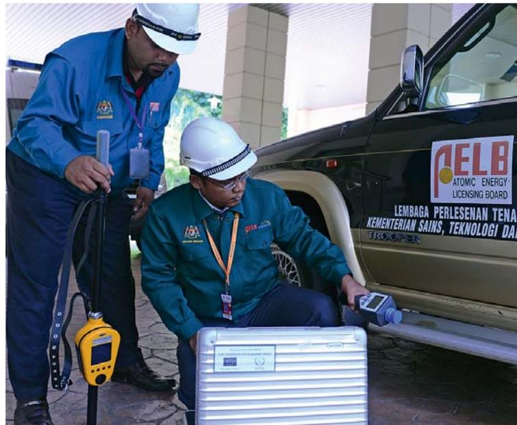
**10** Un funcionario de la AELB comprueba el equipo de detección de radiación antes de ir a inspeccionar material sospechoso.
