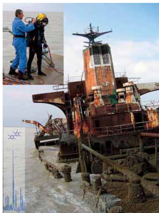
FIG. 2. Muestreo de contaminantes (recuadro superior) y análisis cromatográfico (recuadro inferior) de sedimentos recogidos junto a uno de los 35 buques naufragados en o cerca de las vías de navegación del Iraq.
