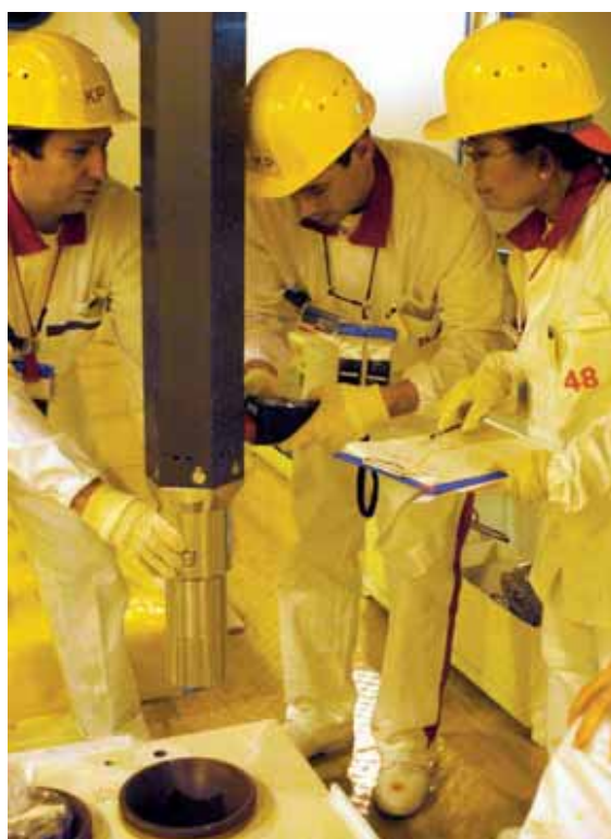
FIG. 1. Inspectores de salvaguardias nucleares verifican la longitud activa de un conjunto de combustible sin irradiar utilizando un sistema de rayos gamma en la central nuclear de Mochovce, en Eslovaquia, durante un ejercicio de adiestramiento.
