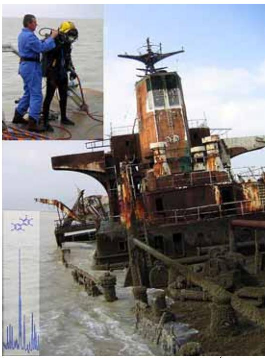
الشكل ٢- أـخـذـ عـيـنـاتـ مـنـ التـلـوـثـ (الـصـورـةـ الـمـصـغـرـةـ الـعـلـوـيـةـ)، وـتـحـلـيلـ كـرـوـمـاتـوـغـرـافـيـ (الـصـورـةـ الـمـصـغـرـةـ السـفـلـيـةـ) لـرـوـاـسـ الـمـاءـ الـعـرـاقـيـةـ وـحـولـهـاـ. جـعـلـتـ مـنـ إـحدـىـ الـ٣ـ٥ـ سـفـينـةـ الـغـارـقـةـ فـيـ أـمـاـكـنـ فـيـ الـمـمـرـاتـ الـمـائـيـةـ الـعـرـاقـيـةـ وـحـولـهـاـ.
