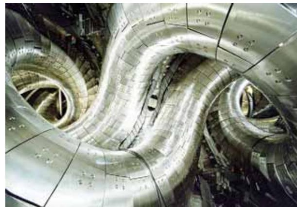
الشكل ٢ - منظر داخلي لغرفة التفريغ بالجهاز الحزروني الضخم للاستثماريور الياباني - التي تجسد مفهوم احتواء الاندماج النووي ب المجالات المغناطيسية حلقة - و تظهر في المنظر الالتواءات الحزرونية المغطاة لنظام اللفائف . ويتم احتواء بلازما الاندماج بواسطة اللفائف داخل غرفة التفريغ.
