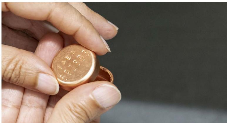
**Se aplican precintos metálicos a materiales nucleares, equipo crítico de instalaciones o equipo del OIEA con fines de monitorización o de otra índole en instalaciones nucleares.**
