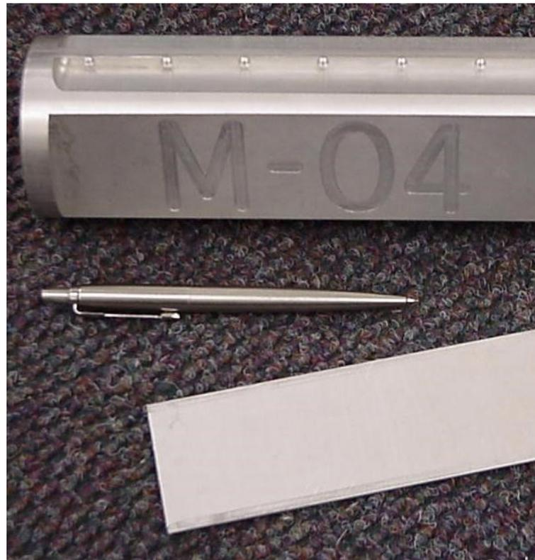
**Une plaque cible de molybdène 99 et le support utilisé pour irradier les plaques dans un réacteur de recherche.**
