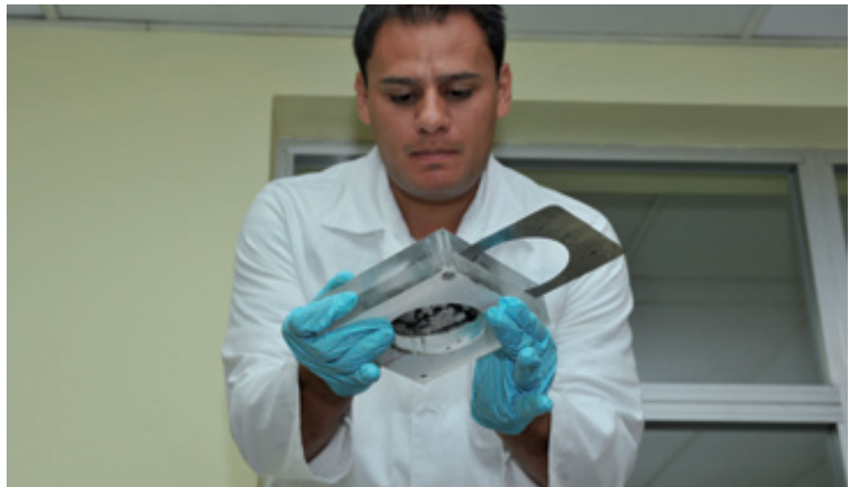
12 Préparer les échantillons pour analyse est un processus complexe qui comporte des tâches variées. Ici, Dennys Canales-Cruz, chef de l'équipe hondurienne, enlève avec précaution une lamelle d'échantillon provenant de la carotte.
