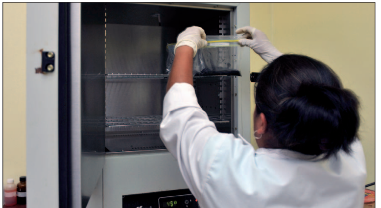
13 然后，小组其他成员按照颜色、纹理、气味等对沉积物样品进行标记并贴上标签。之后，将样品放入烤箱中在控制温度下烘干，然后装运到参加该项目的实验室进行分析。
