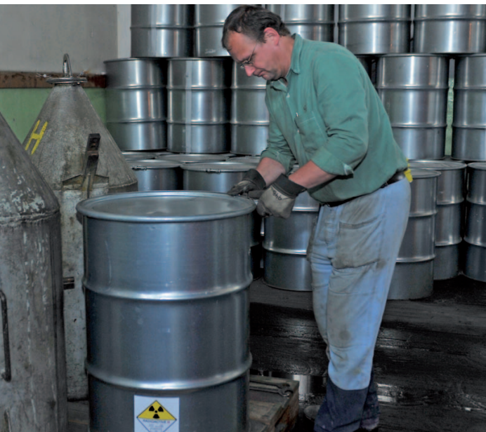
7 黄饼被包装在大小类似油桶的特殊密封铁桶内。每个铁桶充满时重量不超过350千克。
