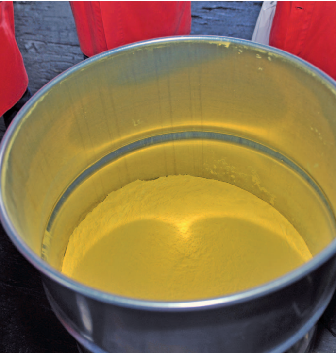
5 铀矿在离矿山几公里处的一座工厂被加工成称作“黄饼”的浓缩物。
