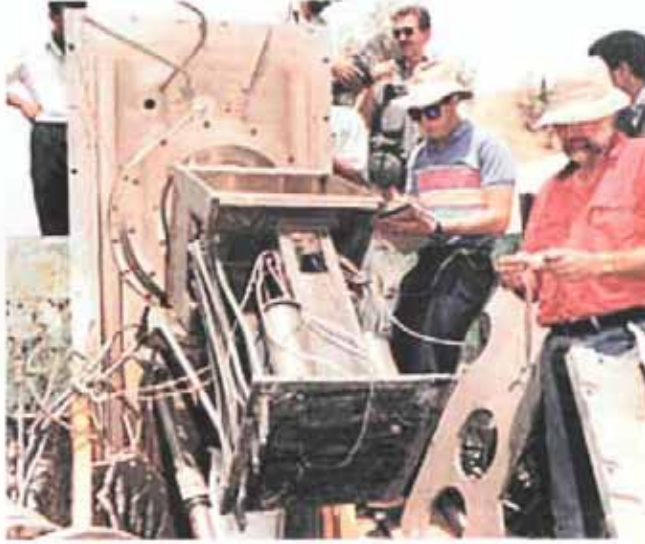
المفتشون وهم يعاينون البقايا لجهاز فصل النظائر الكهرومغناطيسي (EMIS) بعد أن تم تخليصه من بناء مدغشقر بالقنابل.
