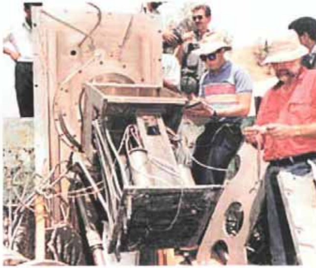
للمفتشون وهم يعاينون البقايا لجهاز فصل النظائر الكهرومغناطيسي (EMIS) بعد أن تم تخليصه من بناء مدعّم بالقنابل.
