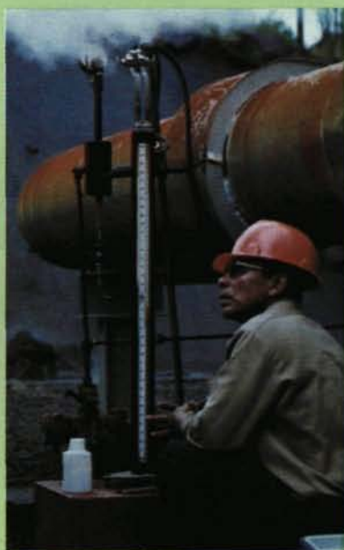
Un técnico de la Comisión Ejecutiva Hidroeléctrica del Río Lempa (CEL) de El Salvador toma muestras de un pozo geotérmico (Cortesía: J. Gerardo/OIEA)
