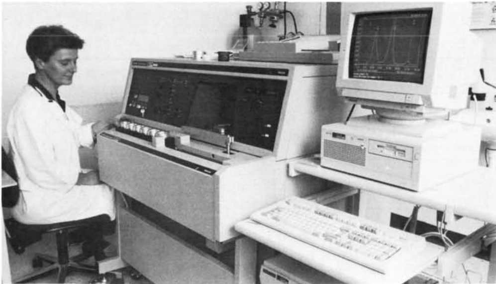
Spectromètre à fluorescence X: un des appareils utilisés pour analyser les échantillons prélevés lors des inspections en Iraq.
