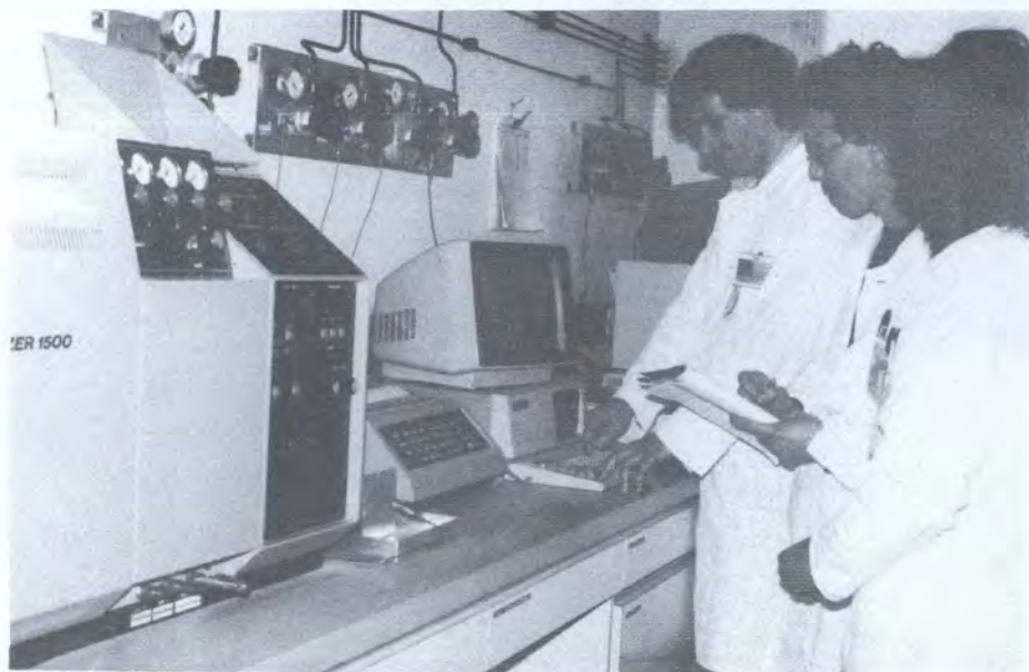
土壤学股备有先进的仪器仪表——例如与稳定同位素比分析仪相连的氮自动分析仪——以提高常规分析服务的样品处理能力，使支助 FAO / IAEA 联合计划的田间项目成为可能。
