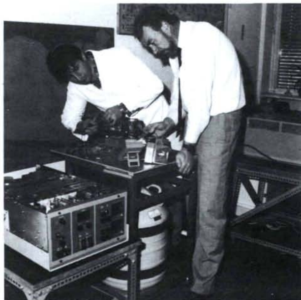
Un boursier de Jordanie apprend à entretenir et à réparer un système d'analyse par fluorescence X utilisé pour un projet de coopération technique de l'AIEA.
