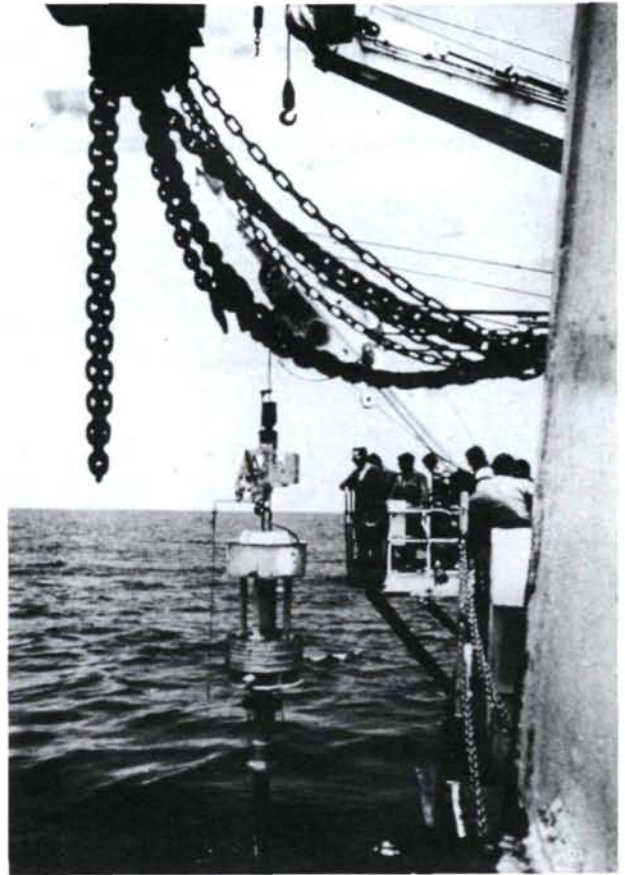
Des programmes nationaux et internationaux permettent de mieux connaître l'impact potentiel du stockage des déchets radioactifs à grande profondeur. Sur cette photo, on peut voir la mise en place pour immersion à 5000 mètres d'un type nouveau de carottier conçu pour prélever des échantillons dans les 30 premiers mètres de la couche de sédiments. (Photo CEA/DPT)
