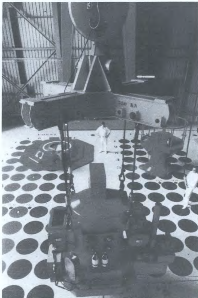
在法国马尔库尔玻璃固化工厂，固化后的高放废物容器被运送到带有通风的井筒中临时贮存。（来源：ANDRA）
