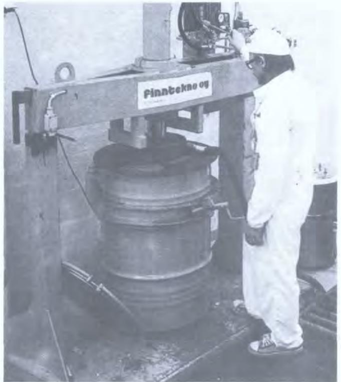
На атомной электростанции Ловиза в Финляндии некоторые виды радиоактивных отходов уплотняются с помощью гидравлического пресса. (Предоставлено YJT, Финляндия)
