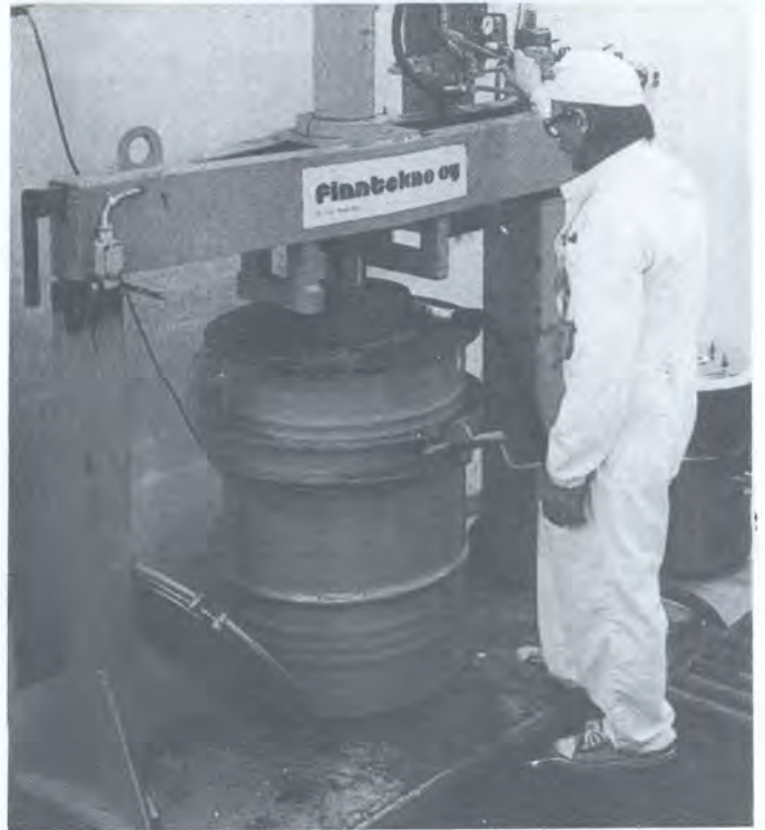
在芬兰洛维萨核电厂，用水压机压实某几种放射性废物。 (来源：芬兰 YJT)
